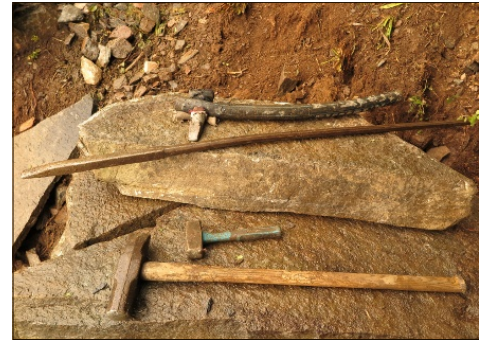
Enkle redskap: Tunge steinblokker blir tilpasset og lagt på plass med handemakt, hammer, slegge, meisel og spett.
